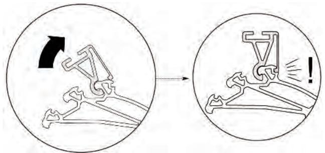
Système d'emboîtement par clips de la patte et du rail pour miniser les outils et les risques liés au travail en hauteur.
